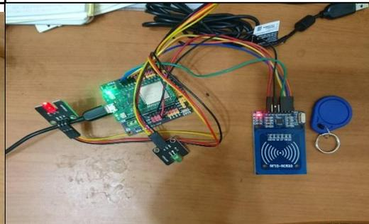
說明：沒有感測到正確的RFID序號，顯示紅燈照片
