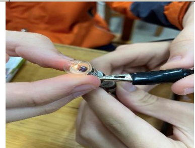
比較三種情況(一個電池、兩個電池並聯、兩個電池串聯)燈泡亮度
